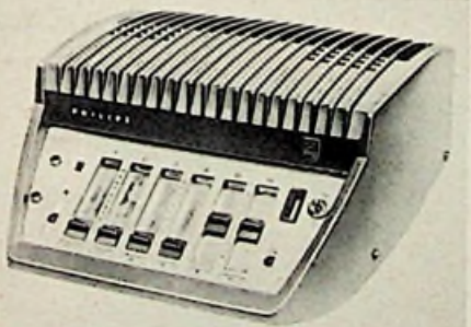
Bild 3. Philips-70-W-Mischpultverstärker in Silumingehäuse mit Flachbahnreglern
