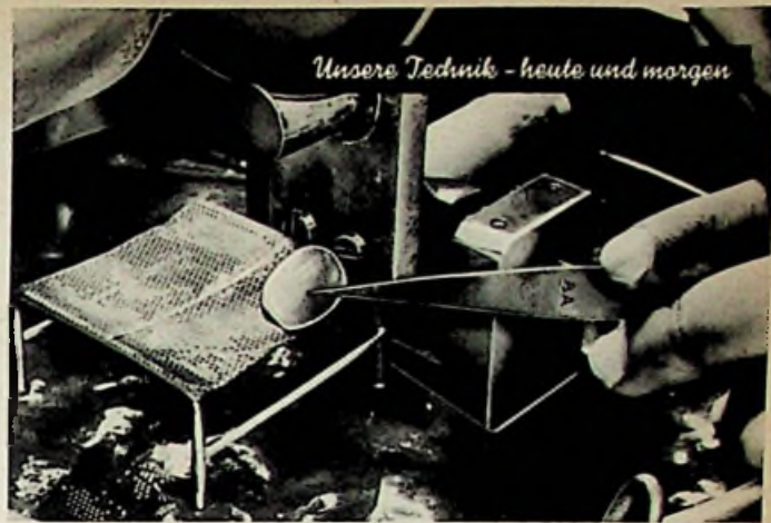
Zerschneiden eines Germanium-Einkristalls in dünne Scheiben mit Diamantsäge in der Transistorfertigung (Telefunken)
