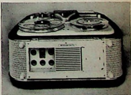
Bild 2a. Die Rückseite des Koffers mit den verschiedenen Anschlußbuchsen
