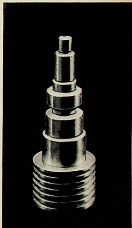
Röhre der Zukunft: Luftgekühlte Scheibentriode RH 6 C mit einer Hf-Leistung von 1,2 Watt im Oszillator-Dauerstrichbetrieb auf 6 Gigahertz (Siemens)
